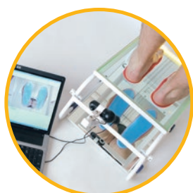
Podoskop – vizualizace rozložení tlaků na chodidlech
